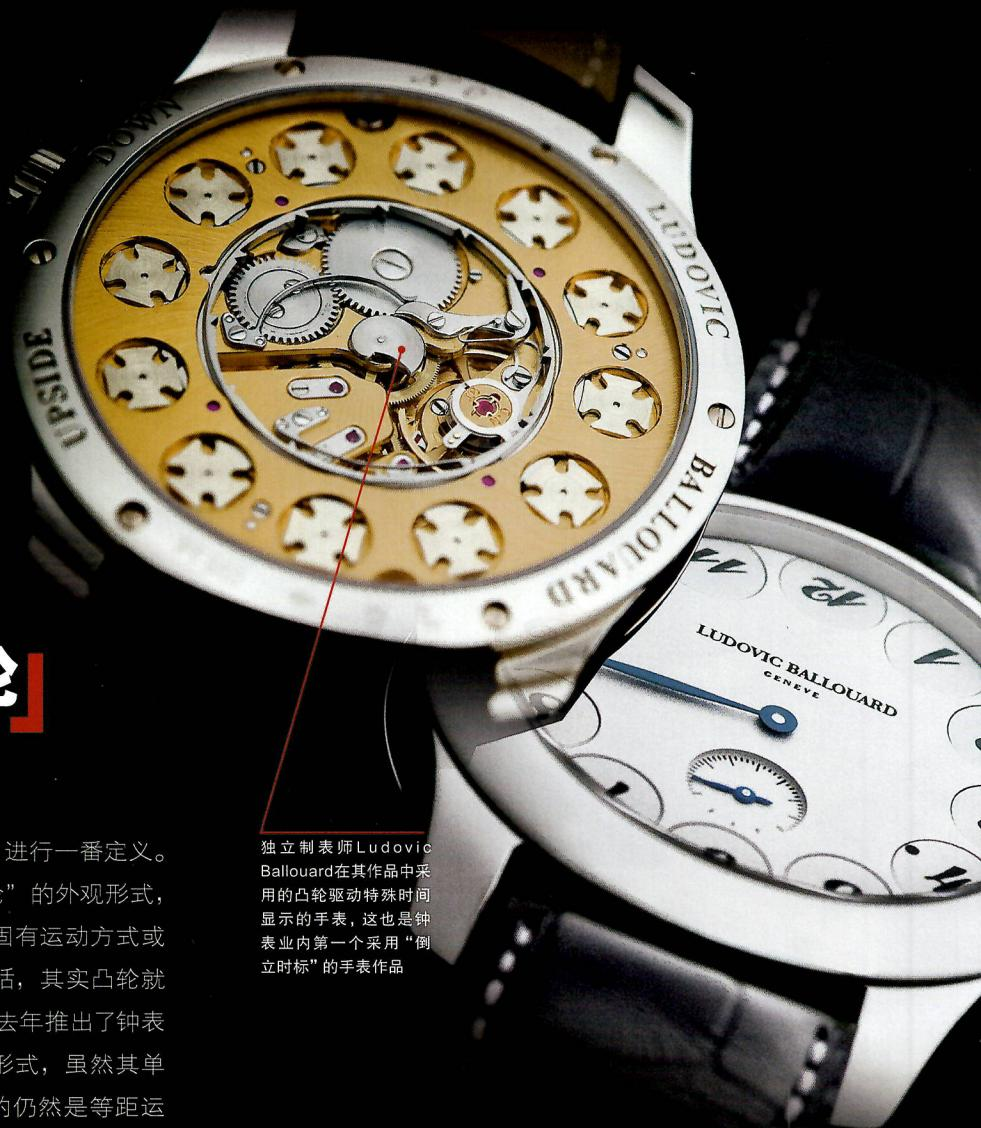
所在的转盘，都由一个被设计成马耳他十字的异形轮驱动（从手表背面可以看到），而 12 个异形轮分别由一根弹簧固定并通过一个贯穿其内圈的圆环操控。圆环内缘带有 12 个斜齿与 12 个单独的时标组件相对应。处于机芯中轴的蜗形凸轮是实现手表整体有序运转的关键。蜗形轮四周光洁润滑，一根形似飞梭的杠杆与其接触，另一端则与控制时标的圆环相互咬合。随着蜗形轮的旋转，飞梭杠杆逐渐地回缩，当蜗形轮转至直径（力矩）最大点处时，杠杆的另一端刚好与下一小时对应的圆环齿咬合，并在蜗形轮转过力矩最大点，回落至基点（力矩最小点）时完成对圆环的瞬间驱动，而相应的小时时标则瞬间正置，上一个小时时标则在弹簧的驱动下，瞬间恢复倒置状态。
