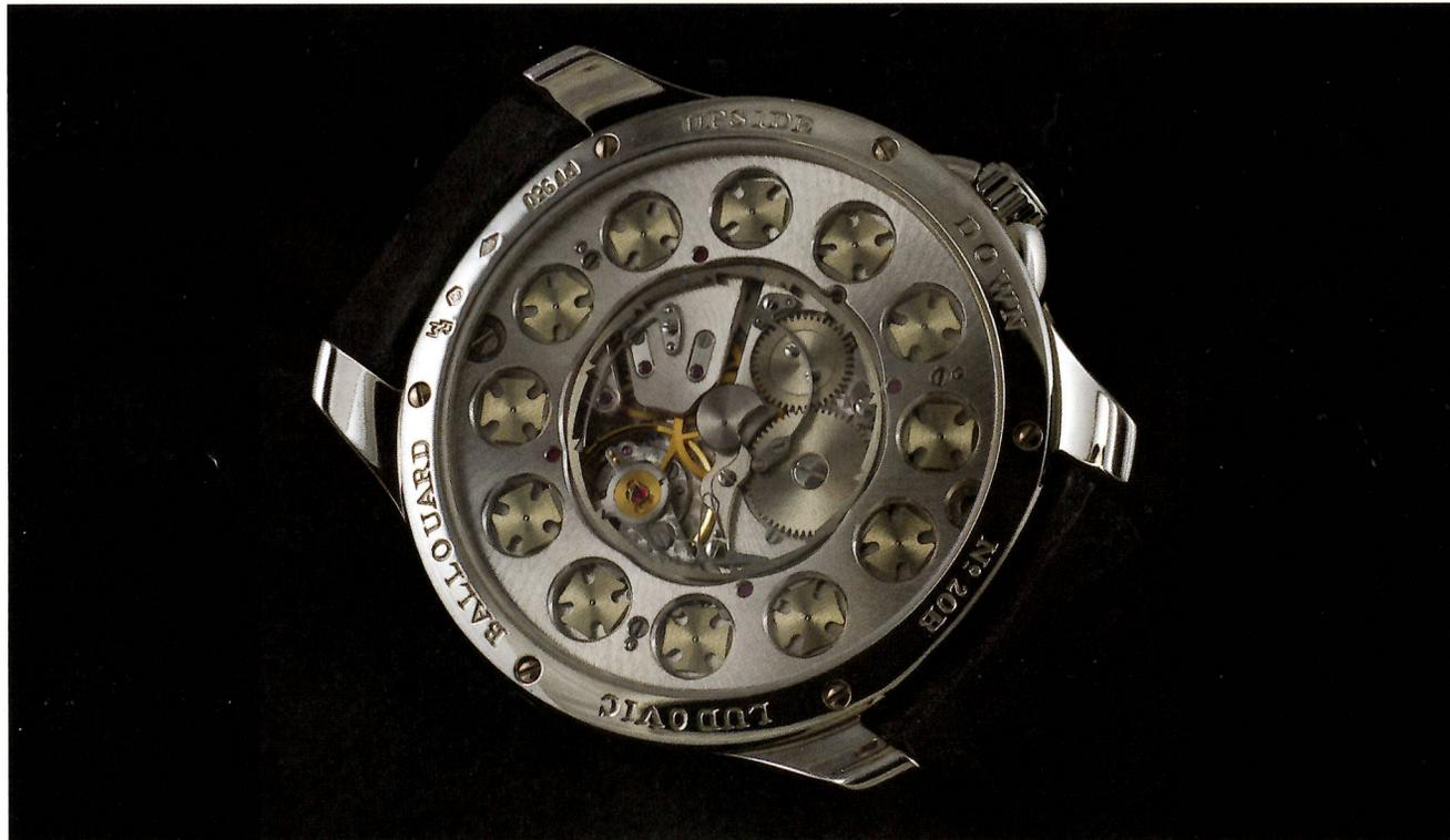
Nel calibro LBO1 dell'Upside Down 12 croci di Malta sottintendono alla rotazione degli indici, ogni 60 minuti. È formato da 228 componenti, ha 36 ore di riserva di carica e una frequenza di 21.600 alternanze/ora.
